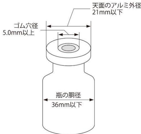
○カプセル部の仕様変更により、天面アルミ外径 21mm 以下の薬剤バイアル<sup>※</sup>の装着が可能です。(上図参照)
